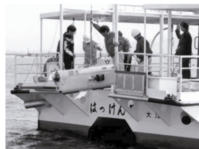
湖沼専用の観測用自律型水中ロボット「淡探」。琵琶湖の水質調査などを行った
