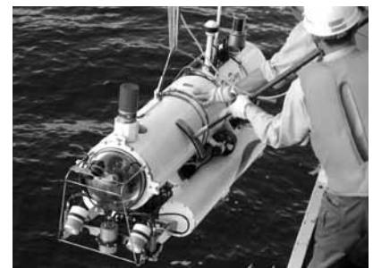
1999年に開発された自律型海中ロボット「トライドッグ1号」。狭い範囲での詳細な観測に用いられる
