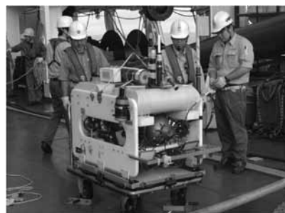
2007年に完成した自律型海中ロボット「ツナサンド」。1500mの深さまで潜ることができ、過酷な環境でも観測を行える
